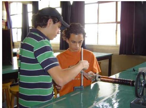
Al tener la bobina terminada, conectamos el enrollado secundario a un par de esferas de cobre con un tubo delgado, también de cobre, soldado a ellas, para lo cual adaptamos una base de madera de la cual disponíamos, para que los elementos quedaran fijos y fuera fácil la reproducción del experimento; para este fin, fijamos a la base de madera dos tubos de acrílico, los cuales perforamos para introducir las esferas de cobre.
