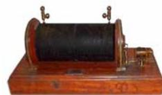
Al cerrar el circuito primario nace una corriente inducida. Debido a la autoinducción, la corriente no alcanza su valor máximo y el interruptor se retrasa, y el campo magnético se anula, por lo que la corriente inducida al
